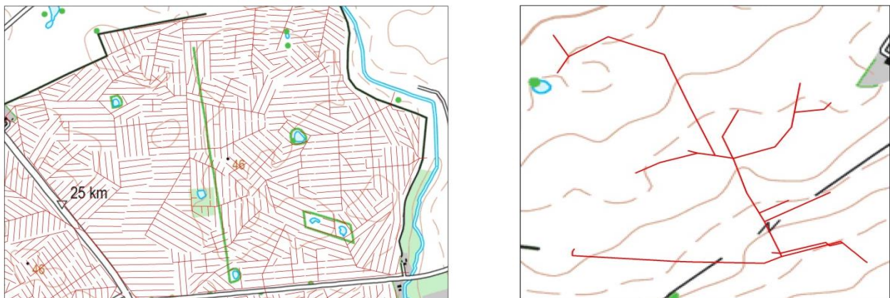
Figur 1 Eksempel på en (a) systemdrænet mark og (b) punktdrænet mark.
